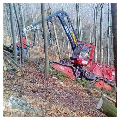
Maschinelle Holzernte mit Vollerter durch Forstunternehmer.
