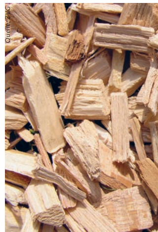
Qualischnitzel – von Feinanteil und Überlängen ausgesiebte und getrocknete Hackschnitzel – eignen sich für kleinere Hackschnitzelheizungen.
