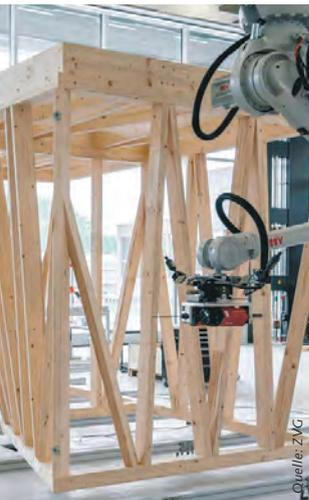
*Holzbau im Labor: Ein Roboter fertigt an der ETH Zürich das geometrisch komplexe Holzmodul*
