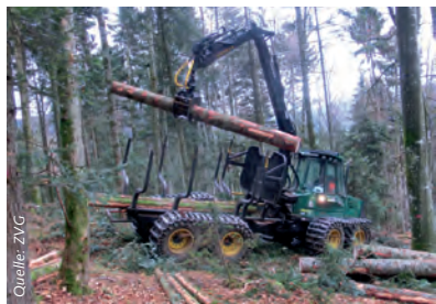
Forwarder mit Bogiebändern zur Verbesserung der Traktion.
