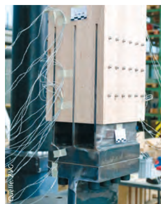
Quelle: ZVG Experimentelle Untersuchungen zum Tragverhalten von Verbindungen in Buchenholz.
